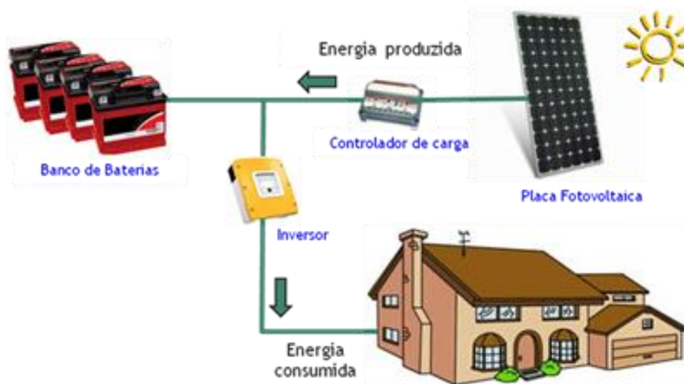
Figura 1.11: Sistema Isolado ( off-grid )
